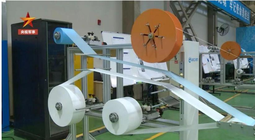
图 4.3.2 中国航空制造技术研究院研发的口罩生产线
