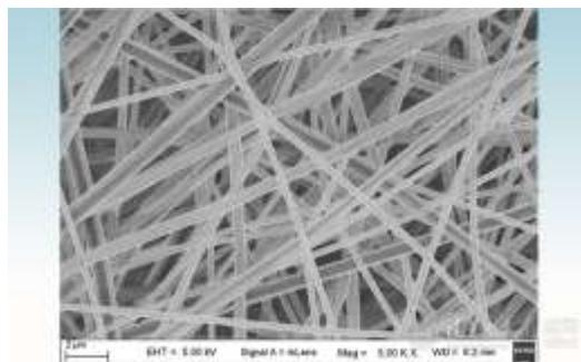
图 4.1.2 团队开发的纳米纤维过滤材料微观相貌
